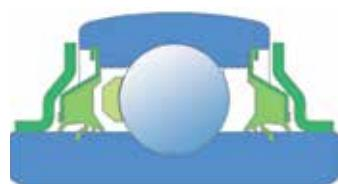
**Fig. 10 Sealing 2PB**
